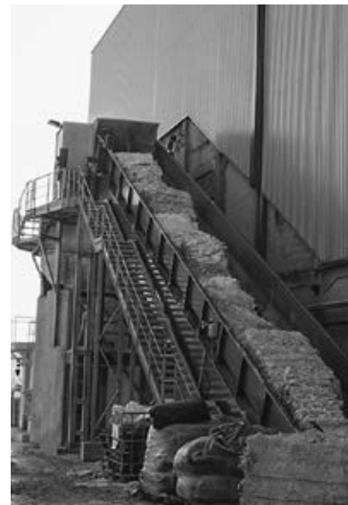
Die anhand ausgeklügelter Rezepturen zusammengestellten Altpapiersorten auf dem Weg in den Pulper.
